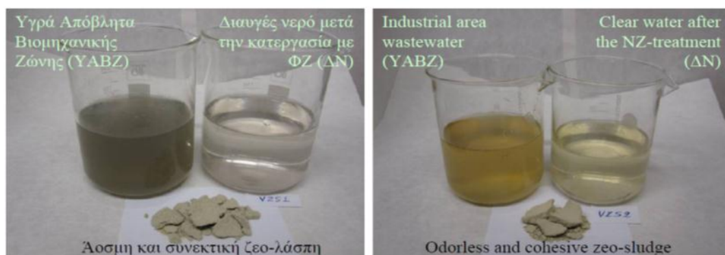
Εικόνα 13: Καθαρισμός υγρών αποβλήτων βιομηχανικής ζώνης [172]
